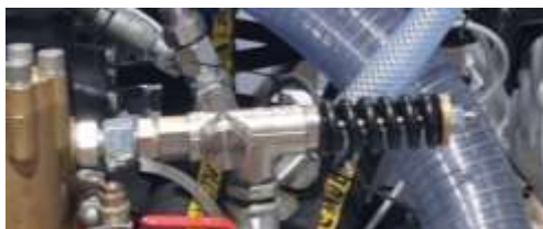
Régulateur de pression permettant de limiter la pression du circuit haute pression et de sécuriser l'opérateur.
